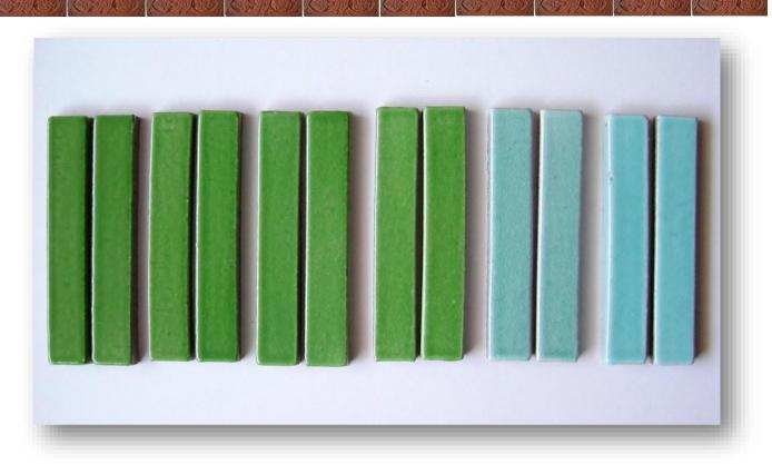
No.375では、**特注 108×20mm ハンドメイドボーダー・**ご紹介致します。製法は湿式ハンドメイド製法です。土練器から帯状に圧縮成形された生地を、ボーダー【108×20×8mm】サイズにカットし、乾燥・グリーン系の釉薬で施釉・焼成して制作致しました。手作り感あふれるミニボーダーで、既製品と違い、個々のタイルのバラツキ・歪等ハンドメイド特有の性質が、全体のバランスの中で安らぎの空間を演出致します。特注色対応可能です。
