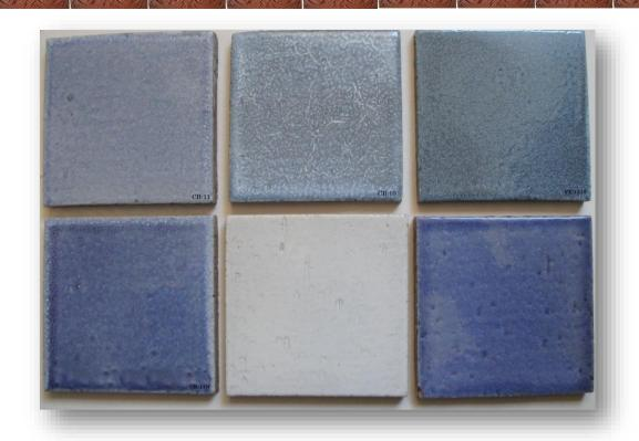
No.387では、**特注 100mm 角ブルータイル**・ご紹介致します。製法は湿式ハンドメイド製法です。土練器で圧縮成形された帯状の生地を焼成後100角になるようピアノ線でカット成形して、乾燥・施釉・焼成して制作致しました。透明感のあるブルー、生地の状態がお楽しみ頂けるブルー、貫入の入ったブルー等様々な個性あるブルーがお楽しみ頂けます。特注色対応可能です。
