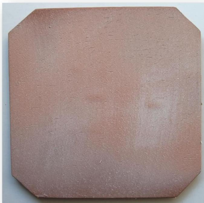
No.409 では、‘特注 300mm ハンドメイド八角形テラコッタ‘ご紹介致します。製法は湿式ハンドメイド製法です。土練器から押し出されてきた帯状の生地を、ピアノ線で焼成後 300mm の八角形テラコッタになるようにカット、乾燥、白のドロ釉をボカして施釉・焼成致しました。施釉・焼成時にどうしても出てしまう個性が、ハンドメイドタイルならではの特徴となり、醸し出される素朴な味わいが空間に安らぎを演出致します。またポイントに色々な選択肢があることも八角形テラコッタの特徴です。特注色対応可能です。
