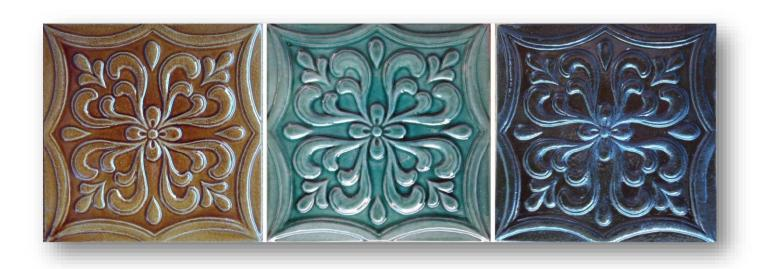
No.426では、**特注 230 角レリーフタイル3色**・ご紹介致します。製法は湿式ハンドメイドプレス製法です。土練器より出てきた帯状の生地を、230 角程度の大きさにピアノ線でカット、そして予め制作しておいた石膏型でプレスし施釉・焼成して制作致しました。色はブラウンとグリーンの軟解釉 2 色と黒色の 2 種類で、軟解釉の場合は、釉薬が溜まった部分は色が濃く、流れ出た部分は色が薄くなり、それが焼き物独特の個性となって、タイル上の凹凸レリーフを強調致します。壁などの空間全面はもちろん、フラット面で構成された空間にポイントとしてもご使用頂けます。特注色・特注形状生産可能です。
