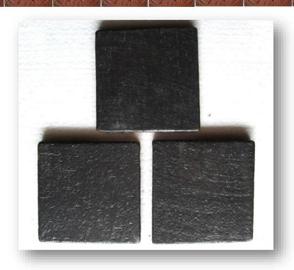
No.433では、'特注ハンドメイド 100mm 角ドロ釉 F 面ブラック 'をご紹介致します。製法は湿式ハンドメイド製法です。土練器より出てきた帯状の生地を、焼成寸法 100mm 角にピアノ線でカット、乾燥、ブラックのドロ釉で施釉・焼成して制作致しました。ドロ釉の場合、その釉薬の特性上、生地表面の凹凸が反映されにくい性質がありますが、それが不思議な面状を表現致します。ザラッキのあるマットな表情のドロ釉、マット釉とは違う独特な表情が再現できます。特注色対応可能です。
