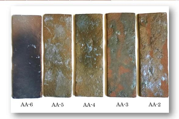
No.435 は、'特注ハンドメイドアンティークブリック 'をご紹介致します。製法は湿式ハンドメイドプレス製法です。土練器より出てきた帯状の生地を、焼成寸法 200×60mm になるようピアノ線でカット、予め制作しておいた型でプレス成型・乾燥、数種類のドロ釉でボカシ施釉・焼成して制作致しました。手作り感あふれる個性的な空間を表現致します。また、高温焼成品ですのでモルタル二次製品にありがちな退色もなく、安心してご採用頂けます。特注色対応可能です。
