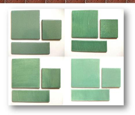
No.451では、**特注ハンドメイド 150・100 角・200×60×8mmGreen タイル** をご紹介致します。製法は湿式ハンドメイド製法です。土練器より出てきた帯状の生地を、各々の焼成寸法になるようピアノ線でカット成形、乾燥・白の化粧土をかけて Green 系の釉薬で施釉・焼成して制作致しました。手作り特有の形状・施釉・焼成のバラツキ感が、各々タイルの個性となって、ご採用頂いた空間を、既成量産品では表現できない優しく柔らかなイメージで表現致します。形状は 300 角程度まで製作可能です。特注色対応可能です。
