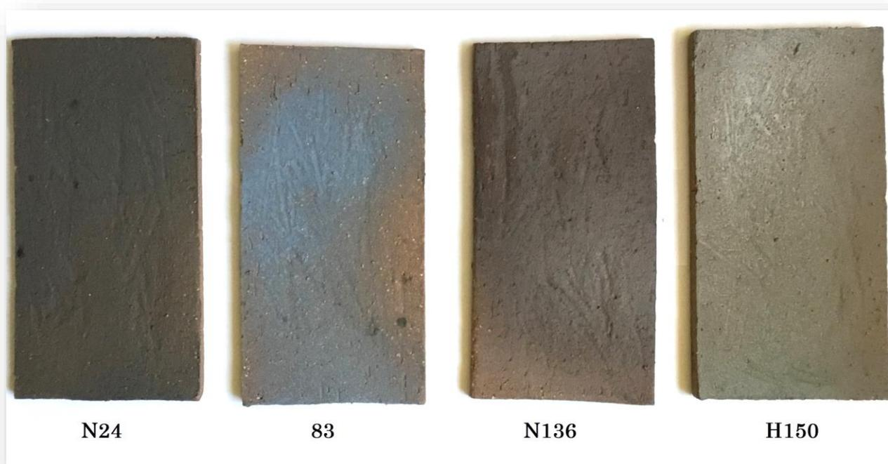
No.460 では、‘特注ハンドメイド 100×200mm グレーブラウン土物タイル‘をご紹介致します。製法は湿式ハンドメイド製法です。土練器より出てきた帯状の生地を、焼成寸法 100×200mm になるようピアノ線でカット成形・乾燥、グレーブラウン系のドロ釉をボカして施釉、一部は手で軽く擦り焼成して制作致しました。手作り製品特有の寸法のバラツキやひずみ、色ムラがタイル一枚一枚の個性となって独特の空間を演出致します。新素材や既製品タイルによる無機質な空間に囲まれた現代に、憩いと安らぎのある昔ながらの手作り感を醸しだします。特注色対応可能です。
