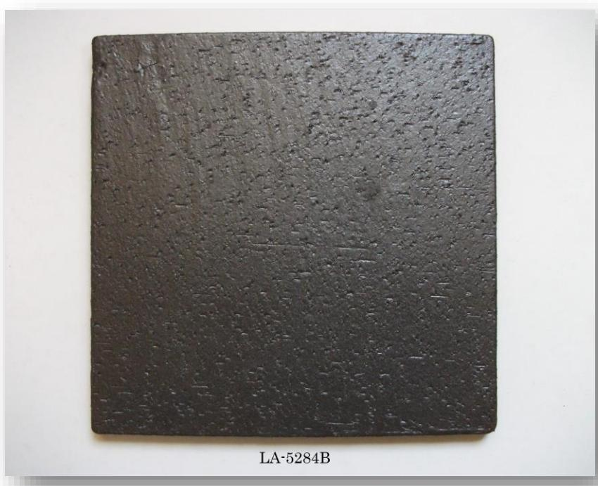
No.472 では、‘特注ハンドメイド 200mm 角ブラックタイル’をご紹介致します。製法は湿式ハンドメイド製法です。土練器より出てきた帯状の生地を、焼成寸法 200mm 角程度になるようにピアノ線でカット成形、そして自然乾燥・生地の表情が釉薬面に出るように黒のドロ釉で施釉・焼成して制作致しました。一概に黒といつても多種多様な釉薬があり、今回は釉薬面で生地の表情が感じられる釉薬を施釉してみました。黒一色で塗りつぶされるのではなく、生地の凹凸感や質感が息づく仕上がりになり、素朴な手作り感をより感じる表情になりました。300mm 角程度までの特注形状・特注色対応可能です。
